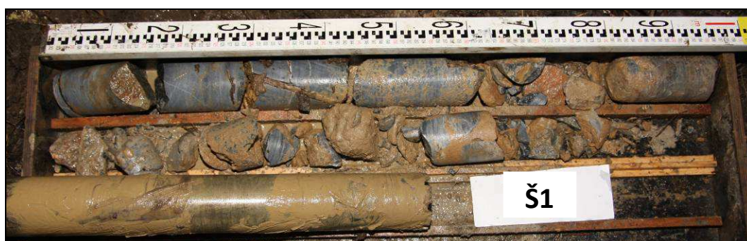
Obr. č. 2 - diagnostický vrt Š1 - pod úroveň základové spáry Libina
